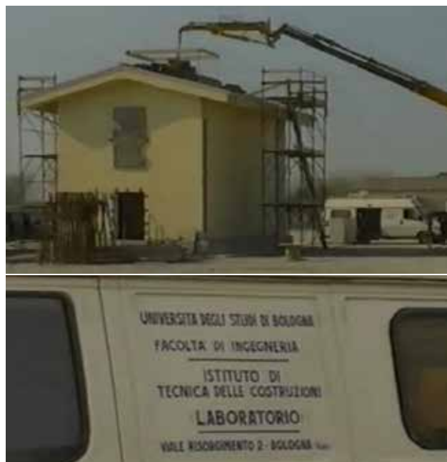
Bâtiment réalisé avec des blocs et des planchers Isotex, soumis à un essai avec Vibrodina par l'Université de Bologne.
