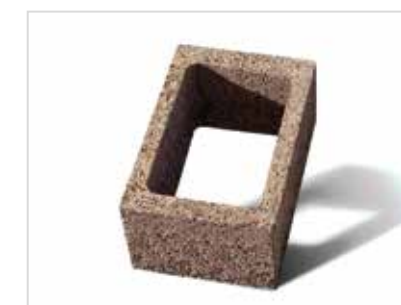
Bloc POTEAU (vide) de 33 cm : section béton 25x38 cm *de 38 cm: section béton 30x38 cm **de 44 cm : section béton 33x39 cm Possibilité d'insérer une couche d'isolant *de 5 cm ou ** de 8 cm
